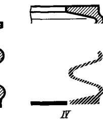
Рис. 731. Гофрированные кольца: I — полугофрированное; II — одногофрированное; III — полуторогофрированное; IV — двухгофрированное
